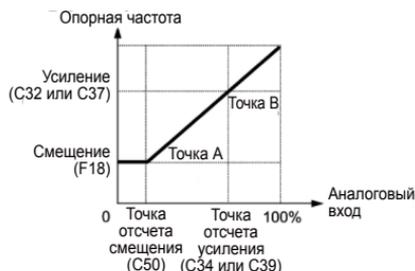
**Пример:** Задайте смещение, усиление и их точки отсчета, когда опорная частота в диапазоне от 0 до 100 % соответствует аналоговому сигналу 1-5 В пост. тока на входном зажиме [12] (команда «частота 1»).
